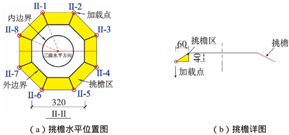
图 4 挑檐加载点示意图 (单位: mm)
