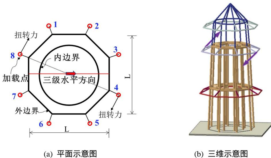
图 7 第二级扭转荷载示意图
