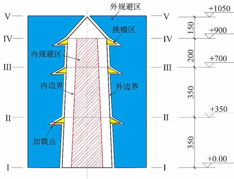
图 2 木塔模型示意图 (单位：mm)
