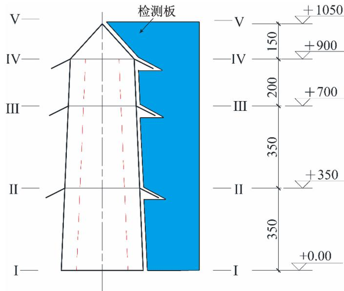
图 10 外边界检测装置示意图 (单位: mm)
