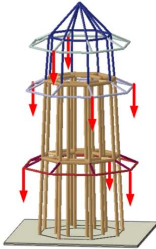
图 6 第一级竖向加载示意图
