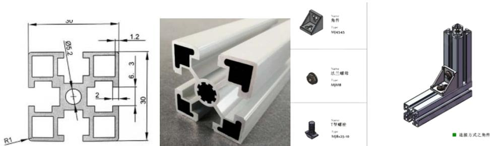
图 A3 45×45 铝合金型材及安装示意图
