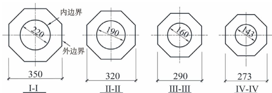
图 3 模型截面尺寸图 (单位：mm)
