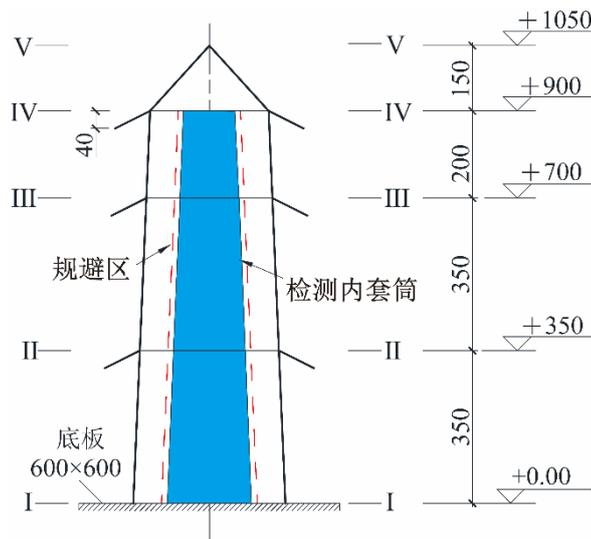
图 11 内边界检测装置示意图 (单位: mm)
